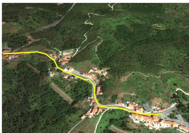
Figura 11: In giallo è evidenziato il tratto di strada in cui è stata realizzata l'asfaltatura antirumore
